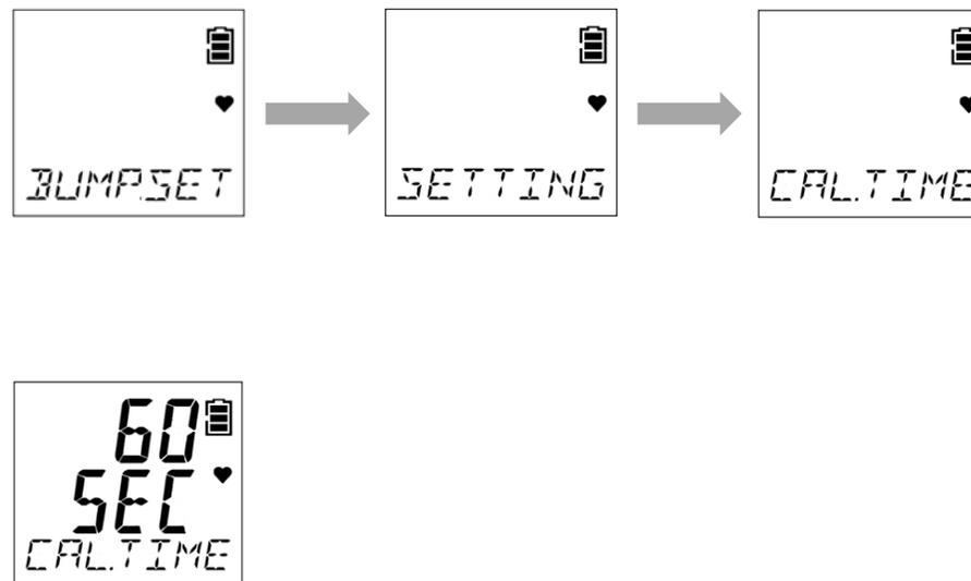
设定后显示 [END]，返回通气测试设定 (SETTING) 的画面。
