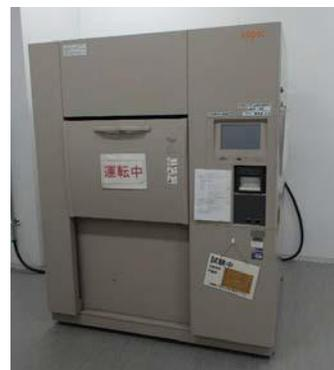
冷热冲击试验装置
