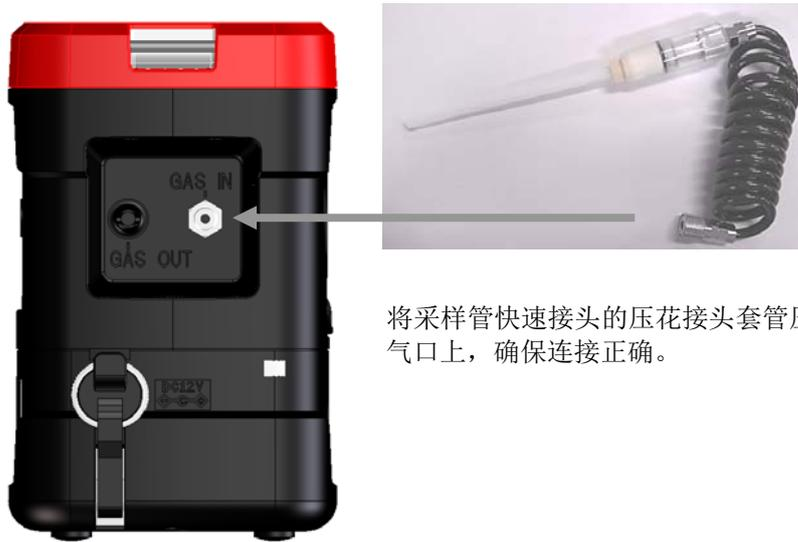
将采样管快速接头的压花接头套管压下后，将快速接头插在仪器的进气口上，确保连接正确。
